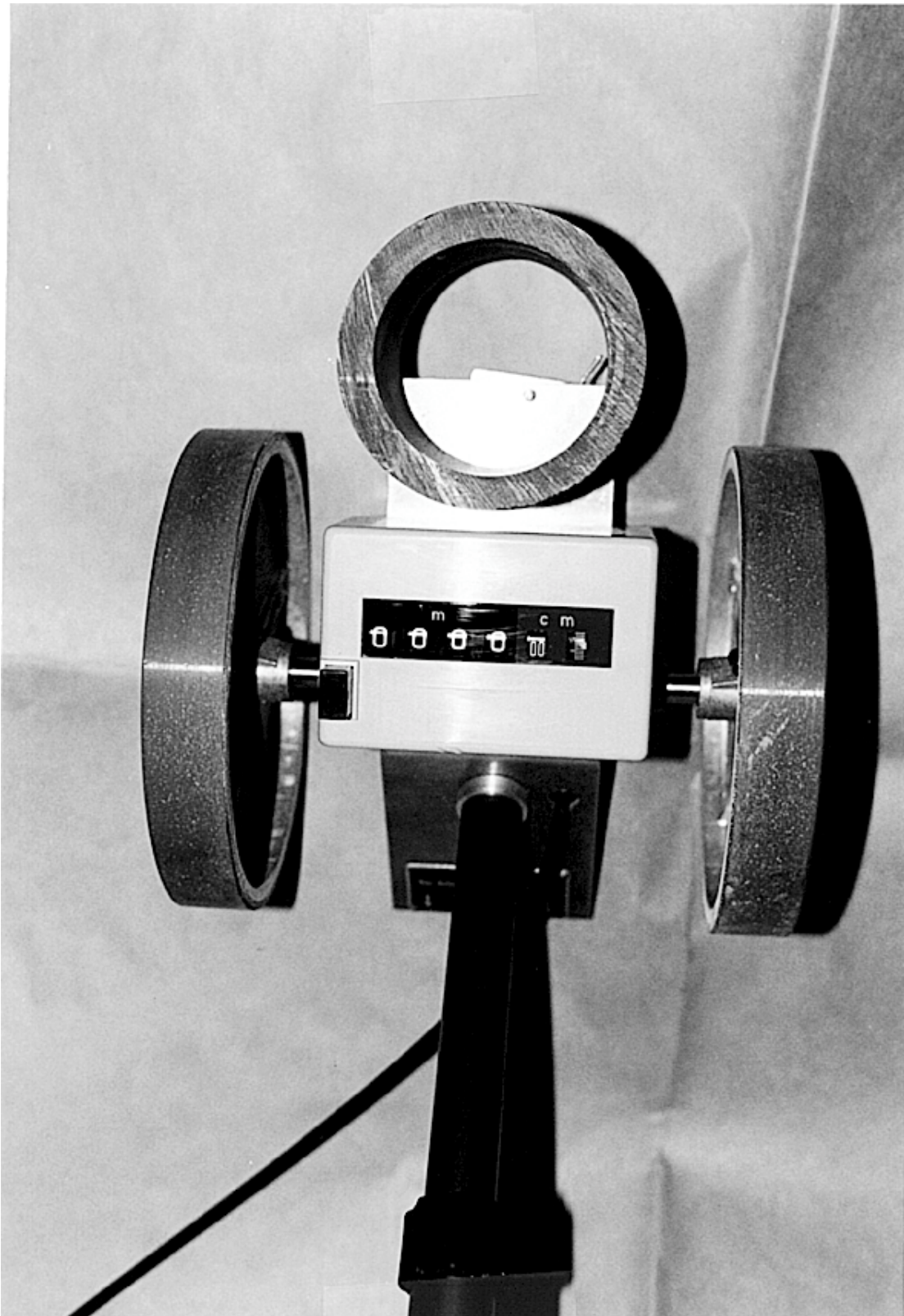
Slika 2: Stroj za mjerenje duljine puta tip 7360 (izgled pokaznog uređaja)
